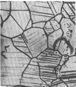
Microfendas formam-se atravessando toda a seção. Em determinado instante, a seção encontra-se mais frágil e verifica-se a ruptura repentina.
