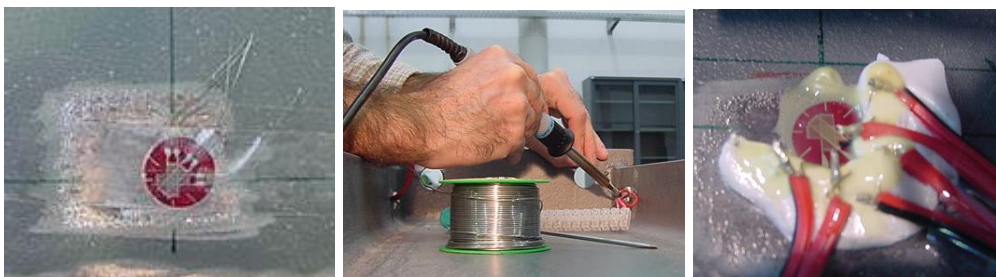
Figura 4 – Instalação de extensômetros em chapas
