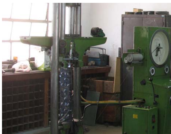
a) máquina universal de ensaios Lousenhausen 600kN
