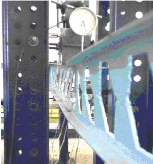
**Figura 2.3 – Viga castelada constituída por furos hexagonais [22]**
