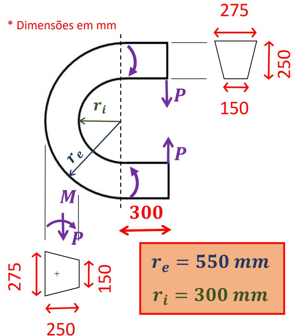
A equação da distribuição das tensões para uma flexão composta:
