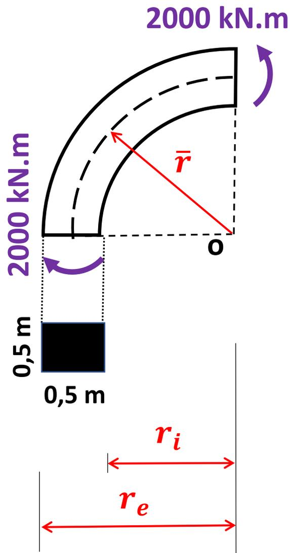
b) Viga curva com raio de curvatura de 2,5 m
