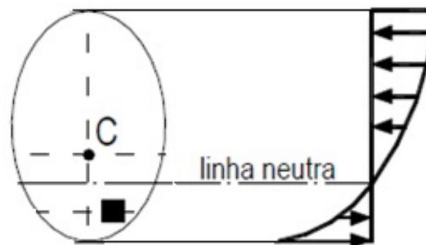
M+ >> tende a transformar a viga curva em viga reta
