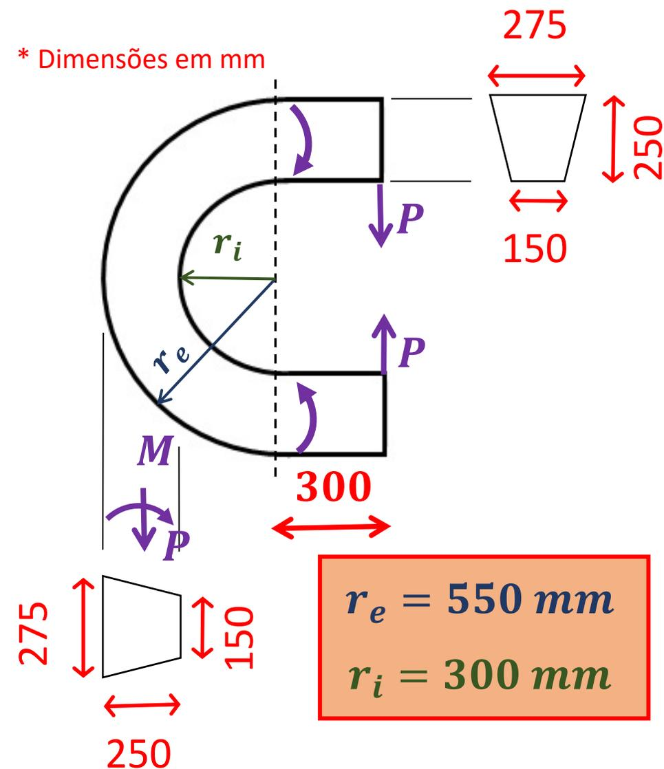
Para este exercício, a aplicação da carga  $P$  irá provar uma combinação (Normal + Momento Fletor) – Flexão Composta
