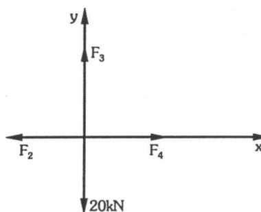
Para determinar a força normal na barra 5, utiliza-se o nó B.
