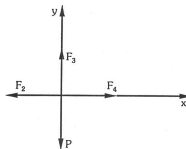
Para determinar a força normal na barra 5, utiliza-se o nó B.
