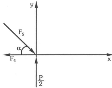
As forças normais nas barras 4 e 5, podem ser determinadas através da simetria da estrutura e do carregamento aplicado.
