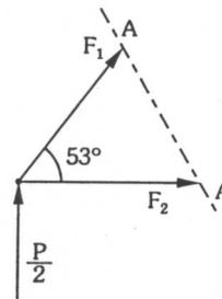
Através do corte BB, determina-se as forças nas barras 3 e 4.
