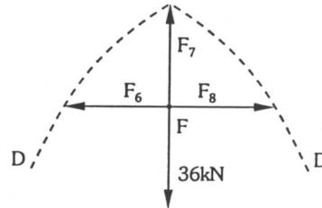
Através do corte EE, determina-se a força axial na barra 9.
