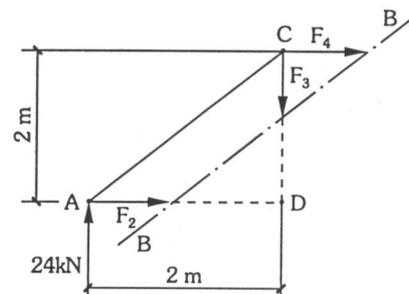
Para determinar as forças nas barras 5 e 6, aplica-se o corte CC, e adota-se a parte à esquerda do corte para cálculo.
